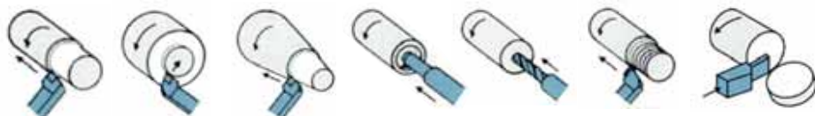
外丸削り 面削り テーパー削り 中ぐり 穴あけ ねじ切り 突切り
